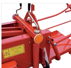
Regulacja stopnia zgniotu realizowana jest za pomocą dwóch sprężyn.
