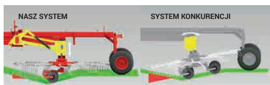
Unikalny system kopiujący – gwarancją dokładnego grabienia oraz mniejszego zużycia części.
