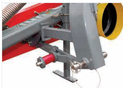
Bezpiecznik najazdowy chroni kosiarkę przed uszkodzeniem.
