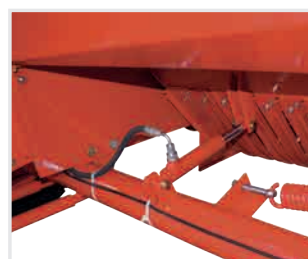
Hydraulika podbieracza umożliwia sterowanie podbieraczem z kabiny ciągnika.
