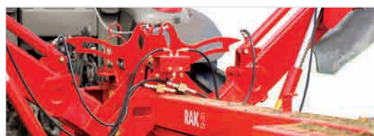
Blokada mechaniczna – zapewnia łatwe przemieszczenie wirników do pozycji dojazdowej oraz pewność w czasie transportu.
