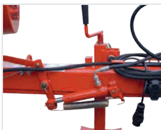
Hydraulicznie sterowany dyszel ułatwia ustawianie maszyny w położenie transportowe lub robocze.
