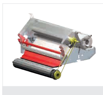
Owijanie siatką - innowacyjny system zapewnia stałe napięcie siatki niezależnie od średnicy rolki. Rolka siatki obraca się z prędkością 10% mniejszą od prędkości obrotowej bel, dzięki czemu jest automatycznie naprężana bez ryzyka zerwania.
