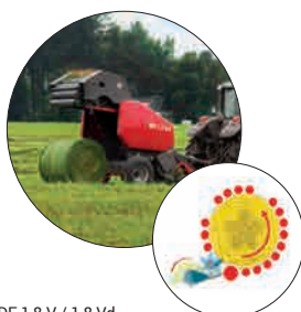
DF 1,8 V / 1,8 Vd Komora łańcuchowo-walcowa – uniwersalna prasa do zbioru wszystkich rodzajów materiałów.
