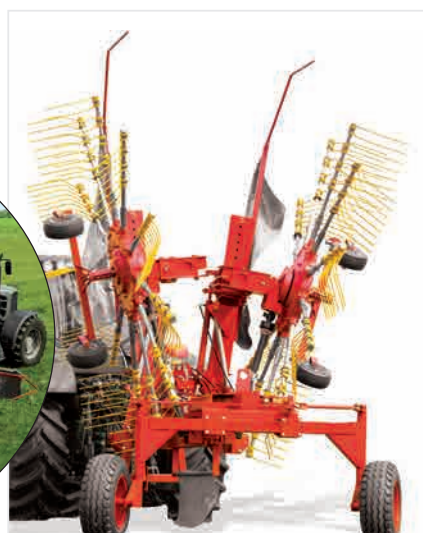
Skrętna oś tylna zapewnia dużą zwrotność zgrabiarki na uwrociach.
