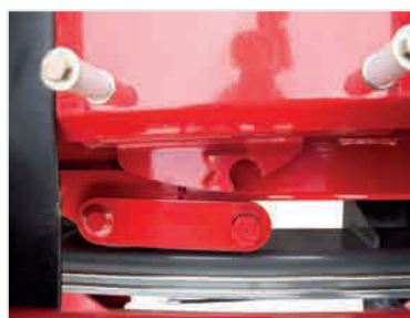
Blokada mechaniczna stołu – stabilizuje stół przy dojazdach oraz transporcie.
