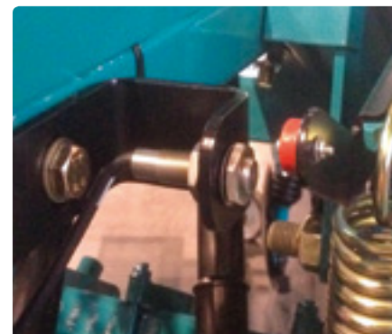
Mocowanie czujników do zliczania przejazdów gdy ścieżki wyznaczone są na siewniku bez znaczników przejazdów
