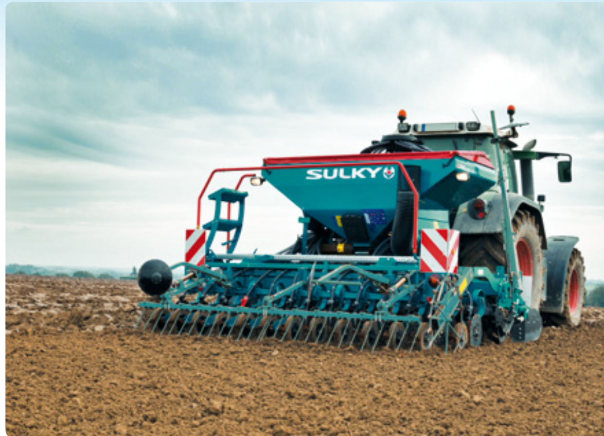
SULKY jako specjalista w siewie zadbało o kompaktowe gabaryty agregatów uprawowo-siewnych (na zdjęciu brona wirnikowa z nabudowanym siewnikiem pneumatycznym XEOS PRO).
